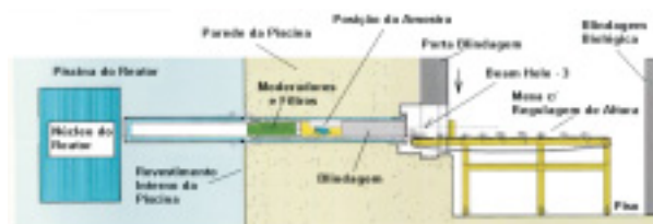
Figura 1: Esquema da instalação para estudos em BNCT
