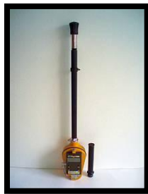
Figure 2. Detector de radiação ionizante de altas taxas de kerma no ar (teletector). O detector possui dois geiger Muller associados a sua eletrônica. O primeiro Geiger Muller possui um range e o segundo Geiger Muller tem como range.
