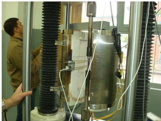
Figura 6. Máquina universal utilizada para ensaios de tração à quente com forno elétrico e extensômetro fixado no corpo de prova.
