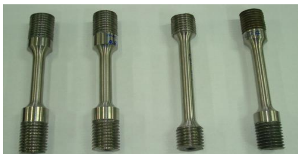
Figura 5. Geometria dos corpos de prova para o ensaio de tração à quente.
