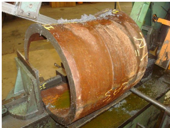
Figura 2. Remoção dos corpos de prova do material na forma de tubo 14", espessura de 27 mm, para realização dos ensaios.
