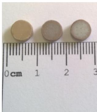
Figura 5: Fotografia das amostras contendo: (a) SrTiO<sub>3</sub> + 1% mol Ca, (b) SrTiO<sub>3</sub> + 2,5% mol Ca e (c) SrTiO<sub>3</sub> + 5% mol Ca.
