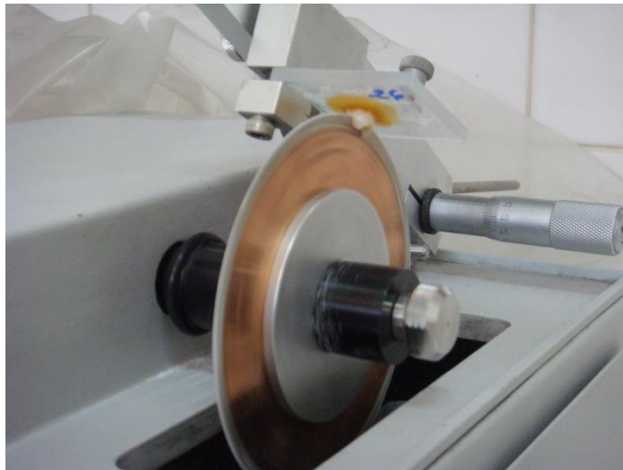
Fig. 1 Corte com disco de alumínio de grão fino para obtenção de blocos de esmalte dentário
