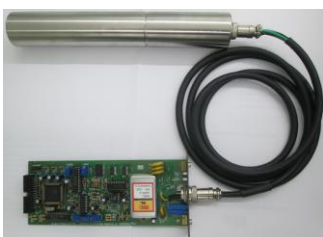
Fig. 3– Unidade do tomógrafo de quarta geração ilustrando o detector (cristal de NaI(Tl) + fotomultiplicadora + divisor de tensão) devidamente encapsulado em aço inoxidável 304.
