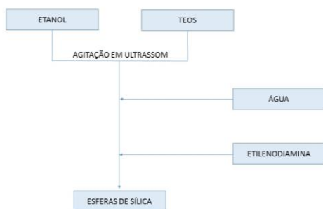
Figura 1: Fluxograma da síntese de esferas de sílica
