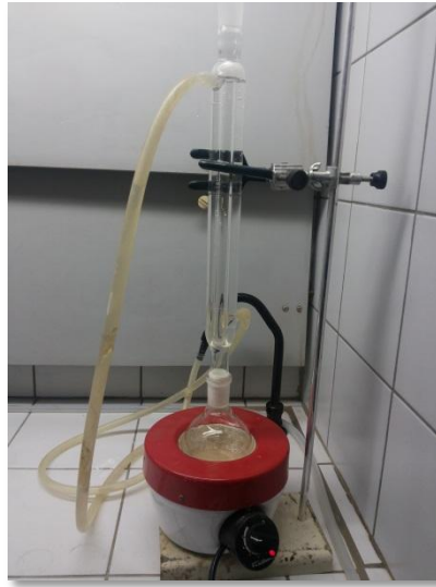
Figura 7. Processo de desacetilação da quitina pré-tratada.
