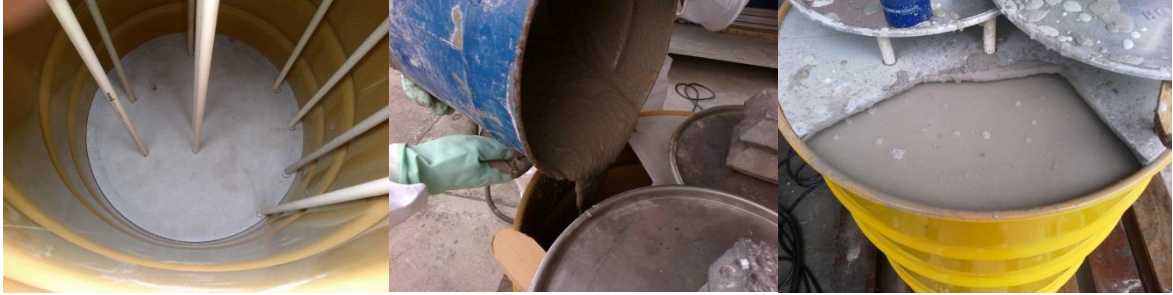
FIGURA 10 - Tambor de calibração preenchido com argamassa de cimento
