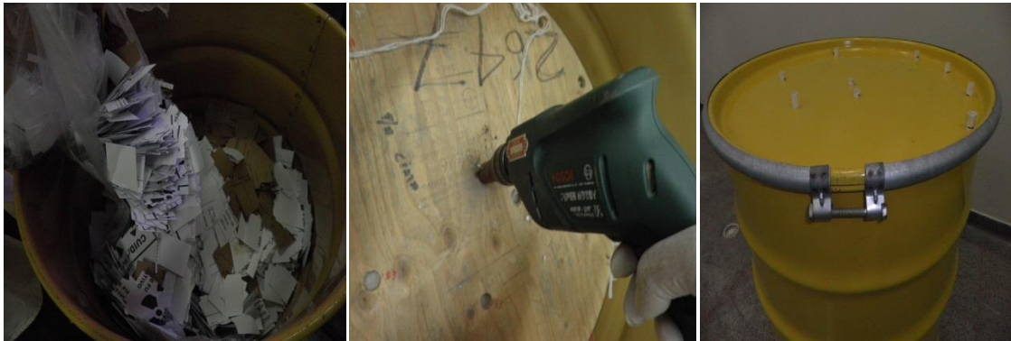
FIGURA 7 - Preparo do tambor de calibração preenchido com papel compactado
