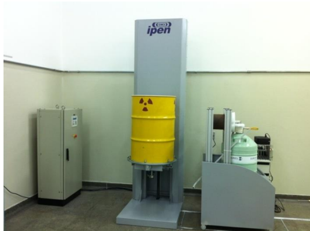
FIGURA 12 - Sistema de caracterização de tambores de rejeito radioativo
