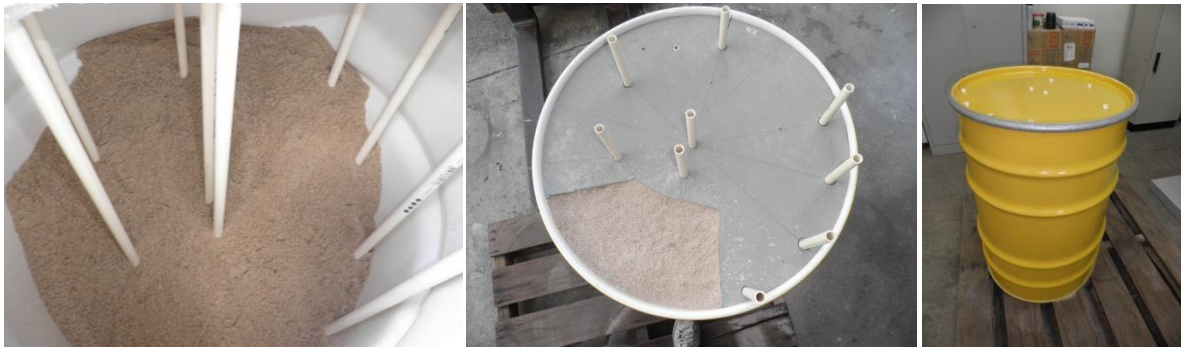
FIGURA 9 - Tambor de calibração preenchido com areia bruta
