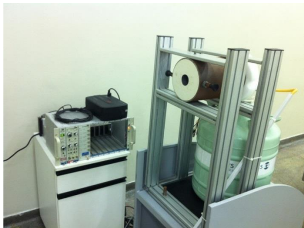
FIGURA 6 - Detector HPGe, eletrônica e colimador
