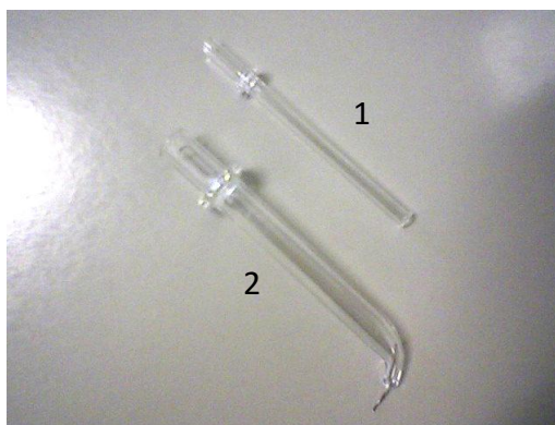
FIGURA 4 – Configuração para a montagem do eletrodo de referência, onde (1) corresponde à camisa interna e (2) à camisa externa.
