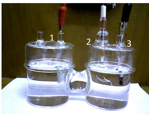
FIGURA 3 – Detalhe do sistema experimental adotado para os ciclos galvanostáticos de carga/descarga, mostrando a célula eletroquímica de três eletrodos, onde (1) corresponde ao contra-eletródo, (2) ao eletródo de referência, e (3) ao eletródo de trabalho.
