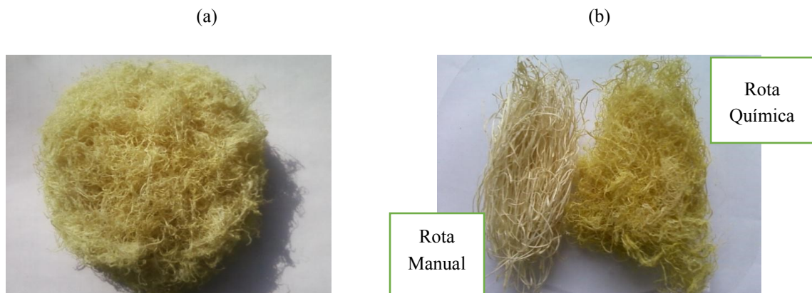
Figura 3: Fibras limpas e secas (a) e diferença das fibras obtidas por duas rotas (b).
