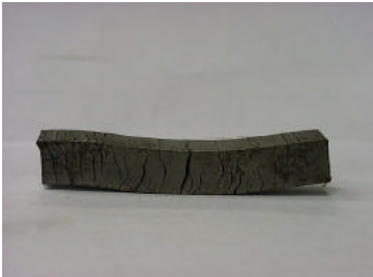
Fig. 5: Aspecto da amostra L21 laminada - Ilustração das estrias.
