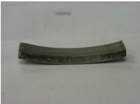
Fig. 7: Aspecto da amostra L22 laminada.
