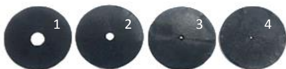
Figura 2. Colimadores para leitura OSL dos dosímetros \text{Al}_2\text{O}_3:\text{C} TLD-500. Eles apresentam 45 mm de diâmetro e suas aberturas centrais são de aproximadamente 10 mm, 5 mm, 2 mm e 1 mm respectivamente.
