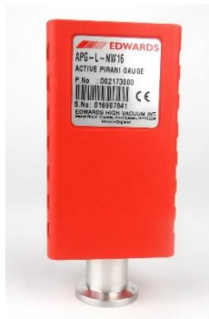
Figura 1. Sensor tipo Pirani modelo APG100 NW16, utilizado neste trabalho
