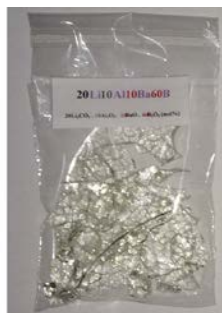
Figura 1: Sistema vítreo, com composição nominal de 20\text{Li}_2\text{CO}_3 \cdot 10\text{Al}_2\text{O}_3 \cdot 10\text{BaO} \cdot 60\text{B}_2\text{O}_3 (mol%), testado neste trabalho para dosimetria de doses altas.
