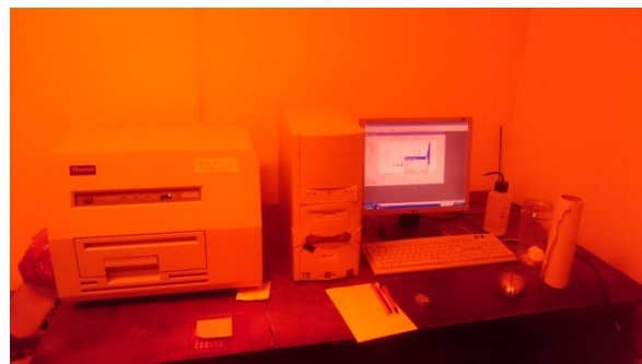
Figura 2: Sistema leitor Harshaw TLD empregado para obtenção das medidas termoluminescentes.
