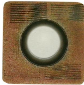
Figura 5. Perfis gravados na pastilha de usinagem pelo método D-Scan para determinação do limiar de ablação do filme de TiN.
