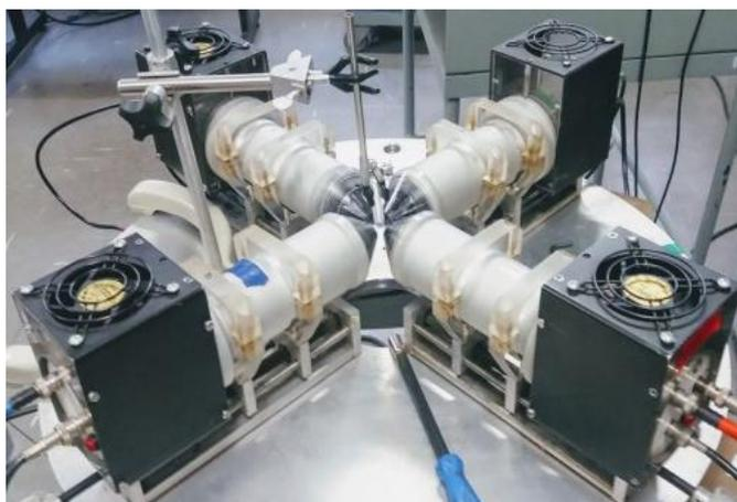
**Figura 4:** Foto do espectrômetro de 4 detectores de  $\text{BaF}_2$  para a aquisição dos dados com a técnica de espectroscopia PAC.
