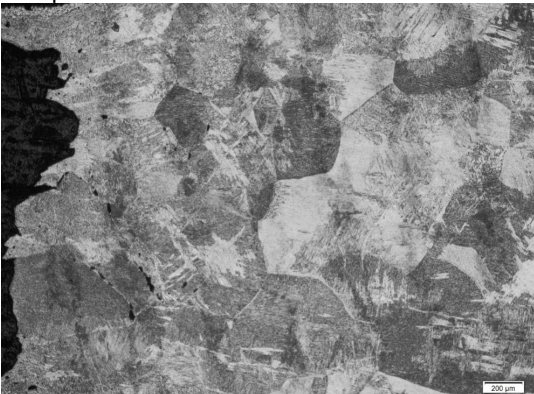
Figura 5 - Microscopia óptica da seção longitudinal do corpo de prova de fluência testado a 600°C e 250 MPa.
