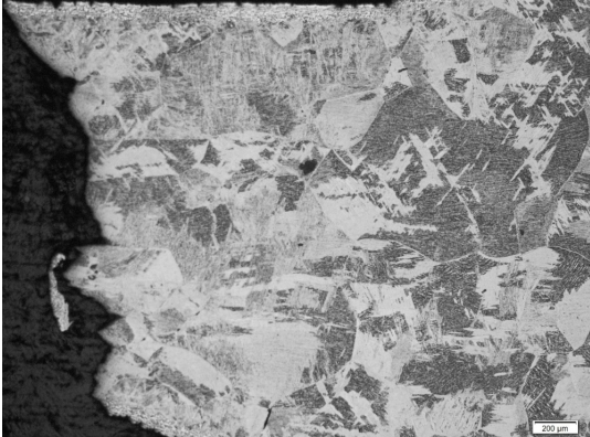
Figura 2 – Microscopia óptica da seção longitudinal do corpo de prova de fluência testado a 500°C e 319 MPa.
