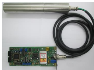
Figura 4– Unidade do tomógrafo de primeira geração ilustrando o detector (cristal de NaI(Tl) + fotomultiplicadora + divisor de tensão) devidamente encapsulado em aço inoxidável 304.
