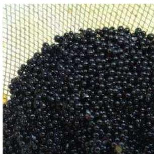
Figura 1 – microesferas de ferrita após a etapa de lavagem.
