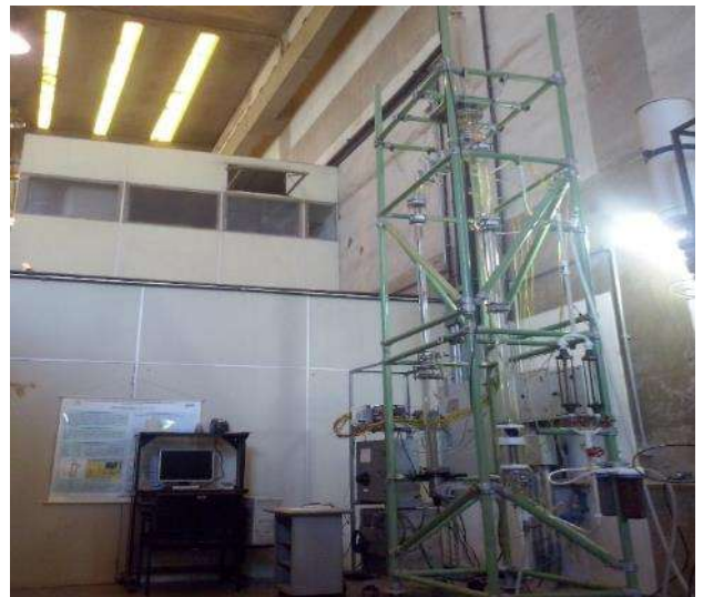
Figura 3. Foto da remontagem do Circuito de Circulação Natural
