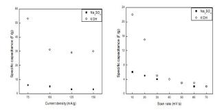
Figura 2. Influência da densidade de corrente nos ciclos galvanostáticos (esquerda) e da velocidade de varredura (direita) na medida da capacitância específica para diferentes eletrólitos.
