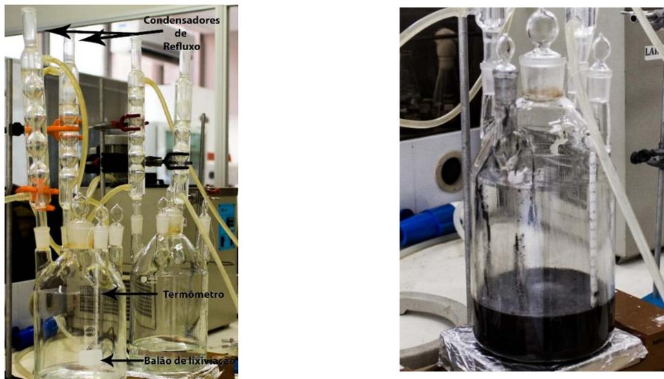
Figura 2 – Fotografia dos balões de lixiviação antes do início da lixiviação (esquerda) e após a lixiviação (direita).
