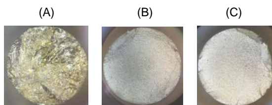
Figura 6- Superfícies de corpo de prova nitretados. (A) Corpo de prova não nitretado ensaiado a uma tensão de 304 MPa e 123700 ciclos (B) Corpo de prova nitretado ensaiado a uma tensão de 406 MPa e 90800 ciclos ensaiado a 406 MPa (C) Corpo de prova nitretado ensaiado a uma tensão de 610 MPa e 35000 ciclos.
