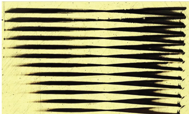
Figura 2. Traços fabricados para a análise pela técnica D-Scan com taxa de repetição de 4 kHz, pulsos de 25 fs e visualizados através de microscópio confocal
