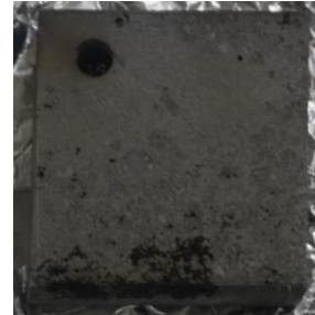
Figura 07 – Corpo de prova metálico após o ensaio gravimétrico (tempo 300 d)
