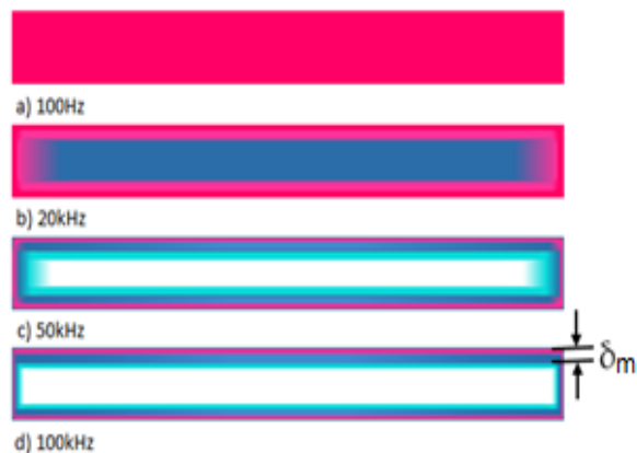
Figura 03 – Efeito pelicular para frequências de 100 Hz à 100 kHz.
