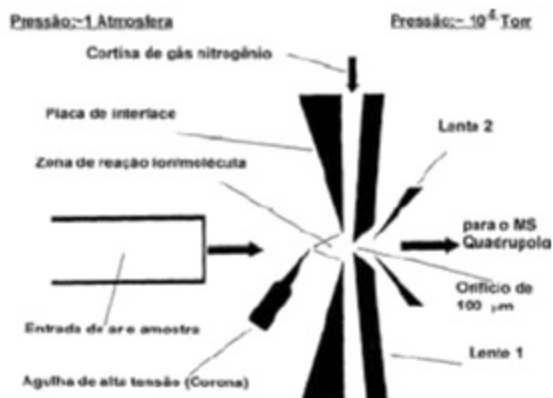
Figura 2. Diagrama esquemático da fonte de íons APCI-MS
