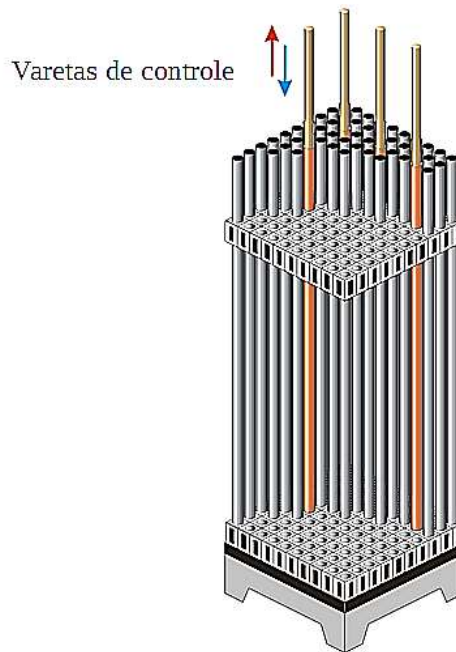
Figura 3 – Ilustração representativa de um Elemento de Controle de um reator tipo PWR. [4]
