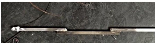
Figura 8. Termopar de aço ABNT 1020 e ferramenta de metal duro de classe P30. Fonte: O autor, 2019.
