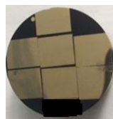
Figura 7 – Amostras embutidas em baquelite.
