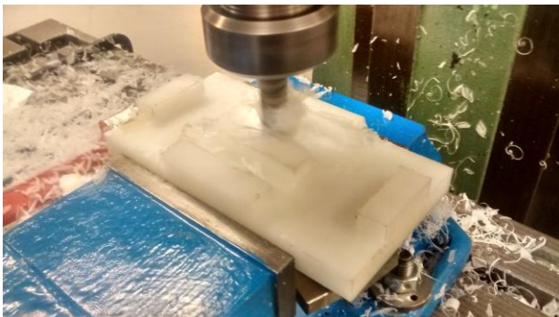
Figura 7. Usinagem da base do mancal na fresadora universal.
