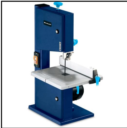
Figura 6. Serra de fita vertical utilizada para cortar o blank em partes menores.
