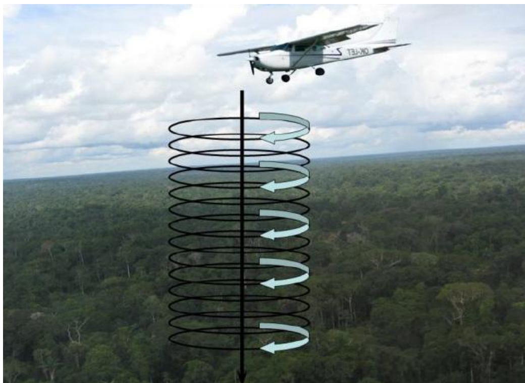
Figura 3- Esquema da trajetória em formato helicoidal descendente utilizada pelo avião de pequeno porte durante a amostragem de ar.
