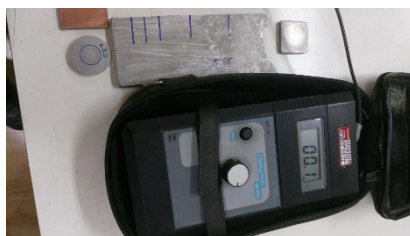
Figura 5 – O Condutivímetro, corpo de prova e sua placa padrão de calibragem. Fonte: autor, 2019.
