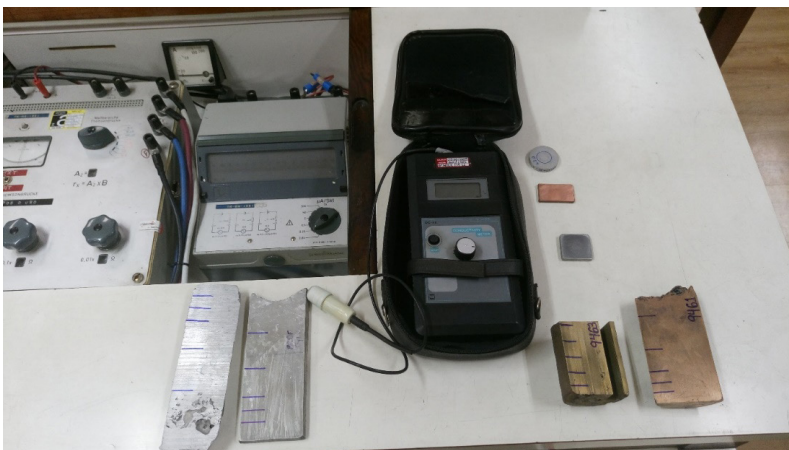
Figura 4 – Equipamento de laboratório da Termomecânica e corpos de prova. A amostra de Al-6%Zn foi ensaiada pelo equipamento eletrônico cujos dados de saída são os valores da condutividade em I.A.C.S. Fonte: autor, 2019.
