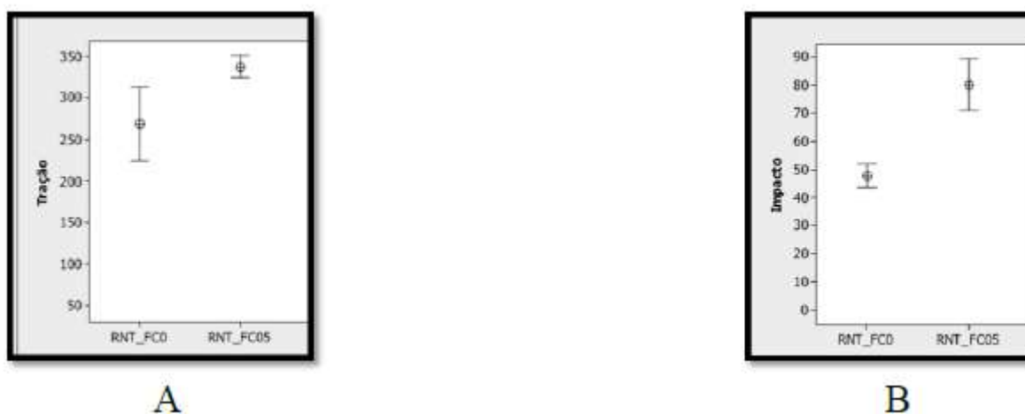
Figura 2 – (A) Limite de resistência à tração; (B) Resistência ao impacto.
