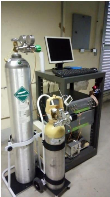
Imagem13: foto do aparelho CRDS em baixo do manifold instalado no trabalho ,junto com os cilindro de gás para calibração.
