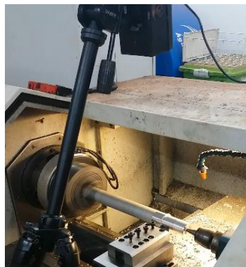
Figura 1 – Termocâmara filmando de cima uma das barras de alumínio que está sendo usinada no torno Romi.
