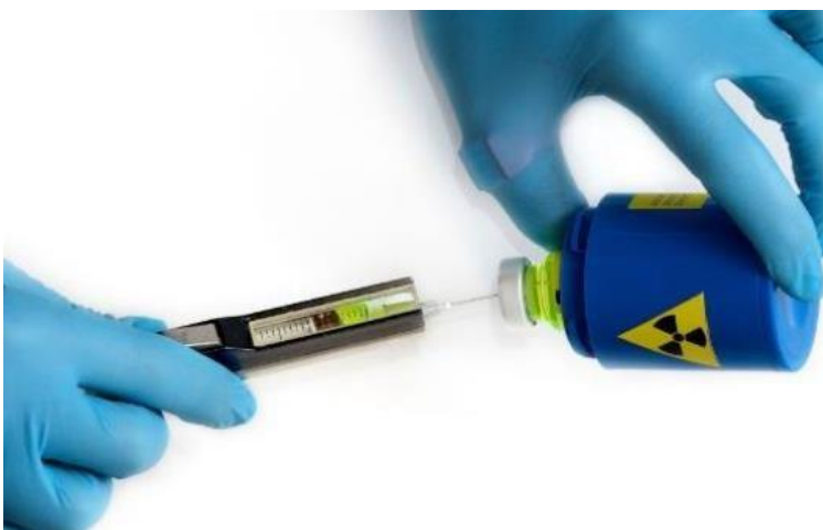
Figura 9 – Radiofármaco líquido sendo aspirado de um frasco protegido por castelinho de chumbo. 23
