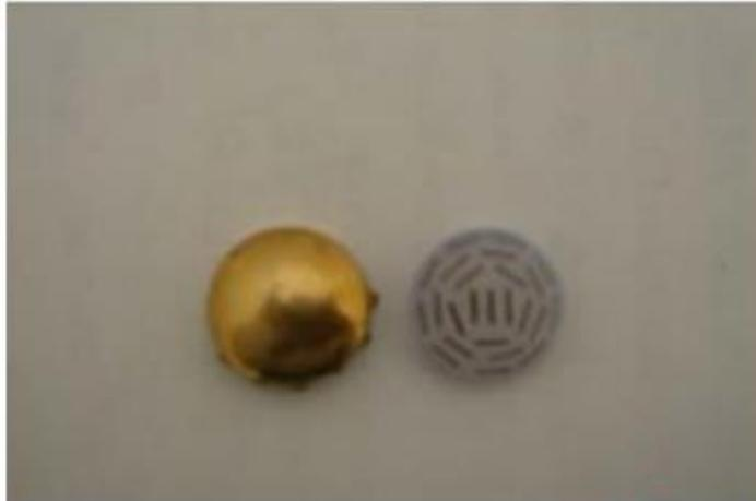
Figura 10: Placa de ouro e suporte de silicone preenchido por sementes de iodo-125<sup>8</sup>.
