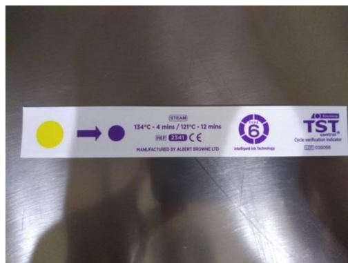
Figura 24: Integrador químico é posto dentro do estojo metálico.
