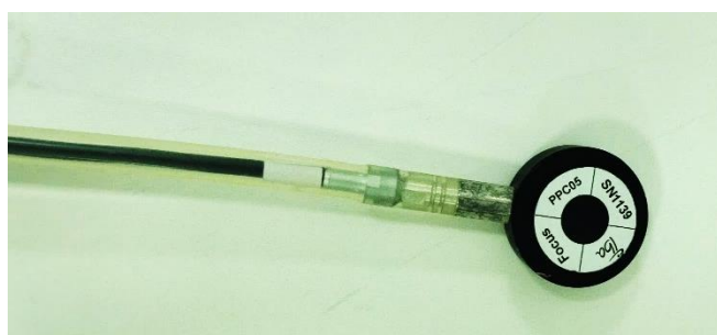
Figura 8: Câmara de ionização de placas paralelas, modelo PPC05. 27,29
