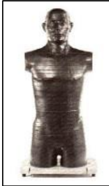
Figura 15 – Phantom ART RANDO Alderson Masculino (homem padrão com estatura de 1,75 m e peso corporal de 73,5 Kg)
