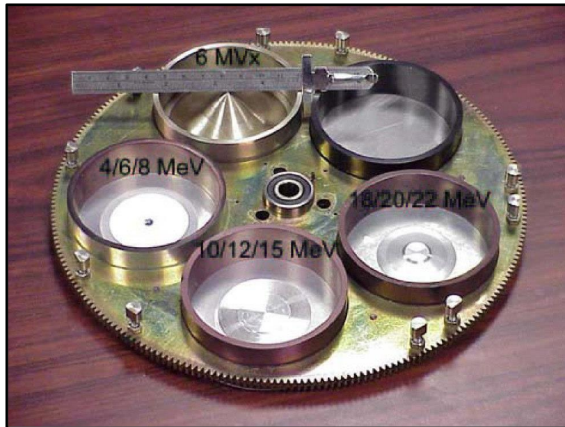
Figura 28 – Carrossel com filtro aplainador para raios X de 6 MeV e folhas espalhadoras para feixes de elétrons de 4/6/8 MeV, 10/12/15 MeV e 18/20/22 MeV de um Acelerador Linear Elekta® SL25
