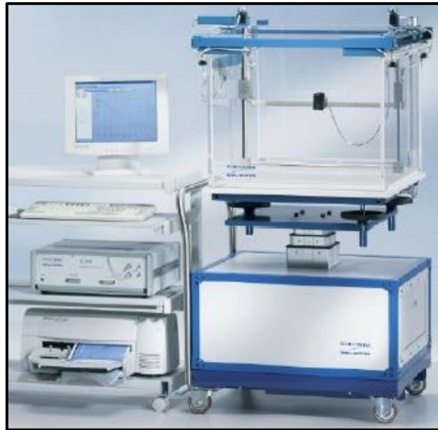
Figura 16 – Blue Phantom da Scanditronix-Wellhöfer juntamente com o sistema de controle
