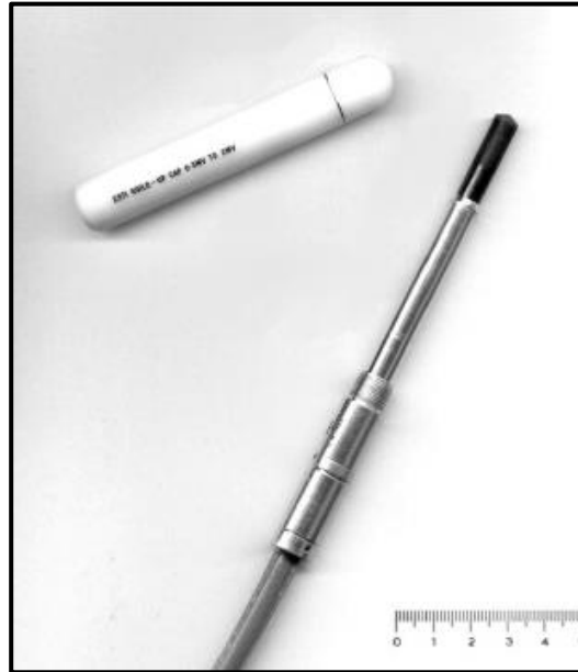
Figura 20 – Aparência física de uma câmara de ionização do tipo Farmer de 0,6 cm 3
