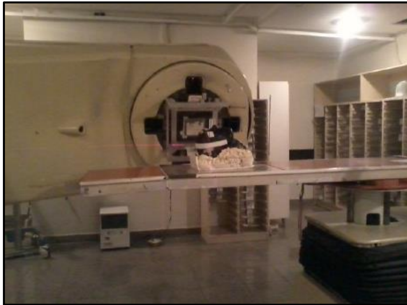
Figura 23 – Posicionamento do phantom em relação ao gantry do AL
