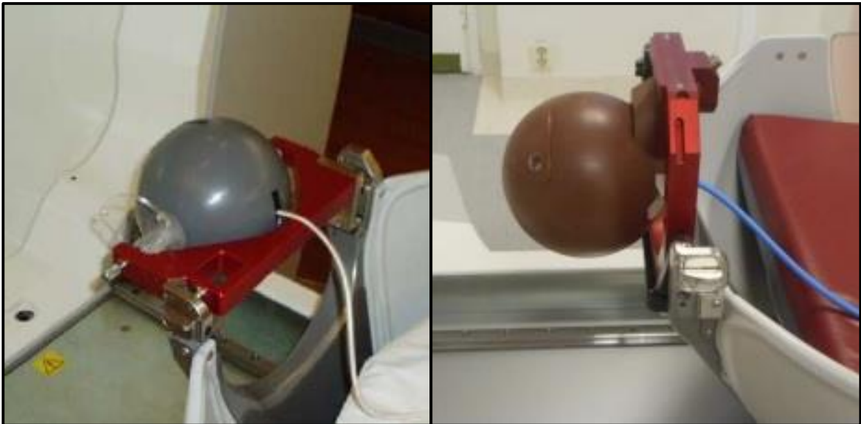
Figura 11 – Objeto simulador de poliestireno (ABS) e de “Solid Water”
