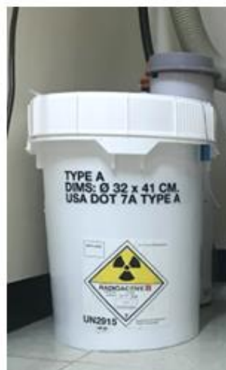
Figura 3 Balde blindado contendo fonte exaurida retirada de operação.
