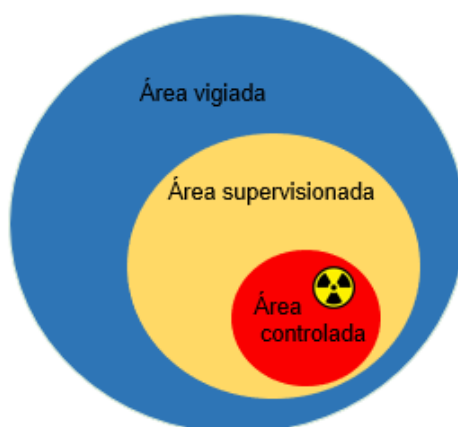
Figura 6 Representação das camadas de proteção crescente das áreas de segurança
