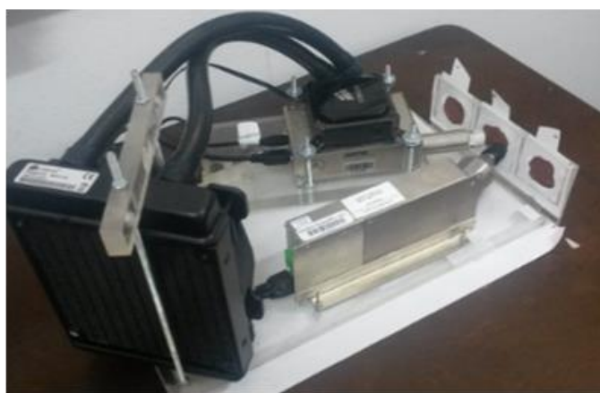
Figura 2. Dimensão do dos componentes do mini-espectrômetro: detector e mini-tubo de Raio X (esquerda). Dimensão do arranjo portátil e compacto de FRX (direita).
