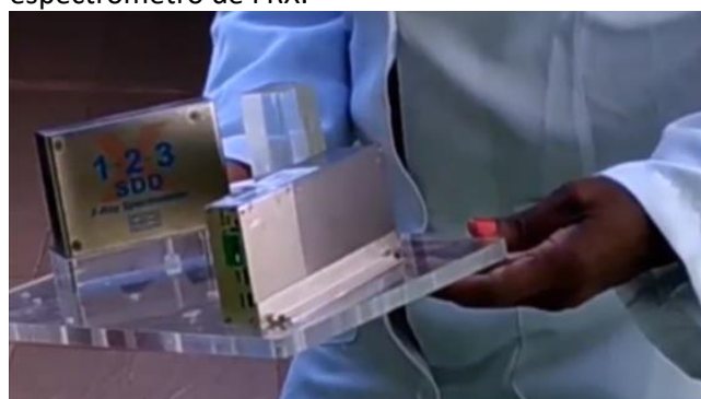
Figura 3. Detalhes da montagem do mini-espectrômetro de FRX.
