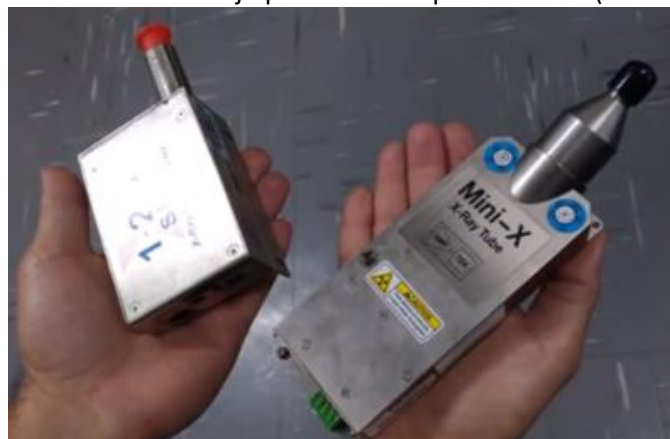
Figura 2. Dimensão do dos componentes do mini-espectrômetro: detector e mini-tubo de Raio X (esquerda). Dimensão do arranjo portátil e compacto de FRX (direita).
