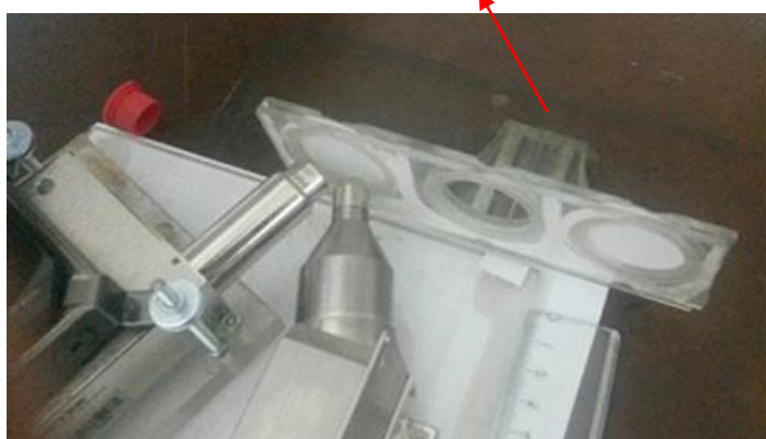
Figura 5. Detalhes da geometria de medida do espectrômetro de FRX, do porta - amostra de acrílico e do posicionamento da amostra.
