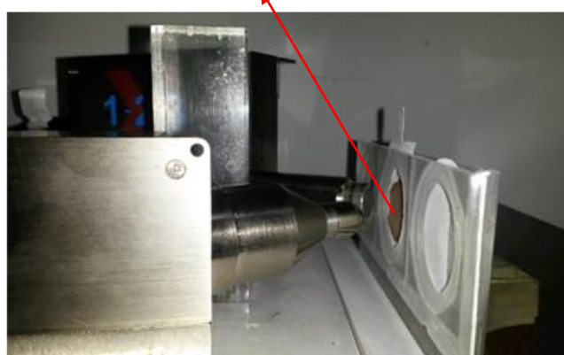
Figura 5. Detalhes da geometria de medida do espectrômetro de FRX, do porta - amostra de acrílico e do posicionamento da amostra.
