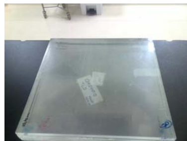
Figura 1: Placas de água sólida (RMI-457) e DTLs posicionados na profundidade de dose máxima.
