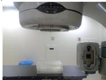
Figura 2: Arranjo experimental da irradiação dos DTLs no HAE.
