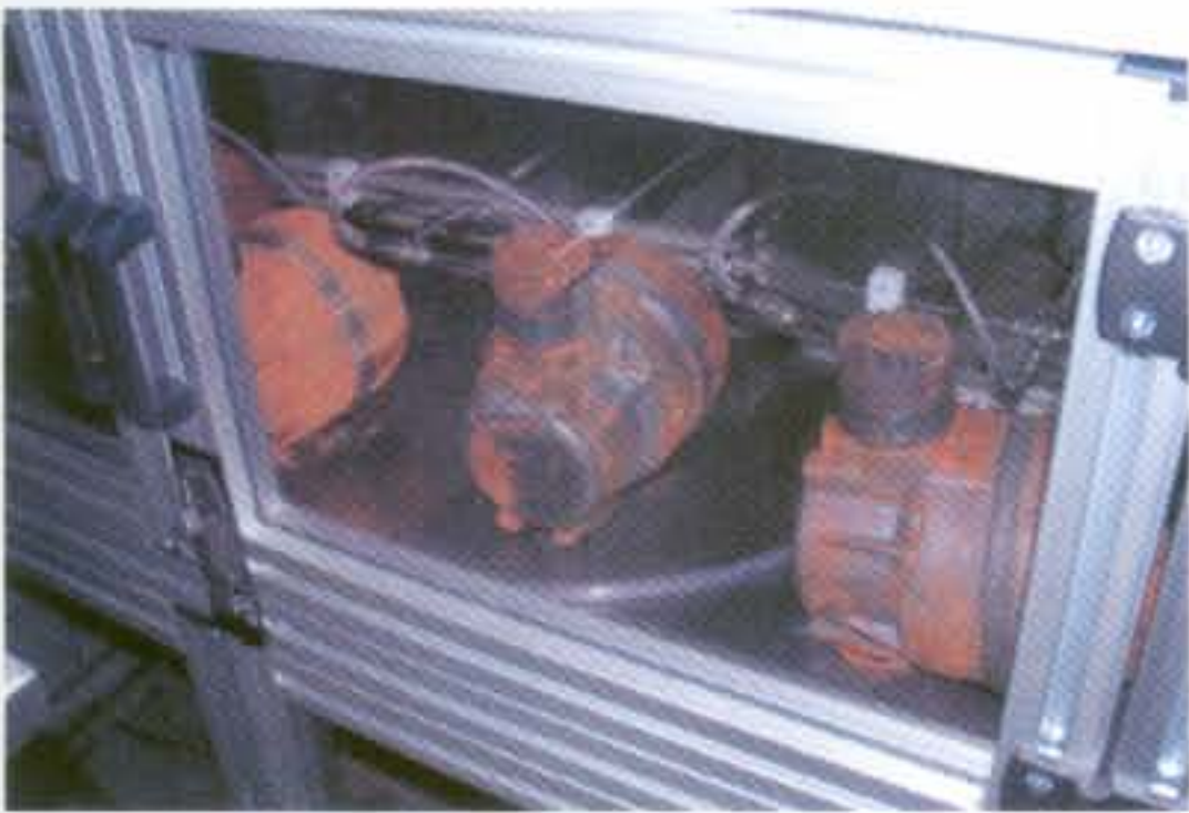
Figura 8a: Prueba de la carcasa del compresor en una máquina desarrollada especialmente
