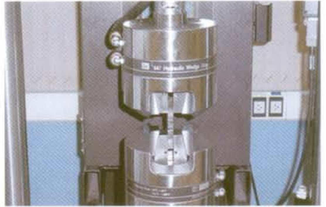
Figura 8b: Muestra cortada del cuerpo principal soldado de la carcasa del compresor y desarrollo de la prueba a fatiga en la máquina universal de tensión axial
