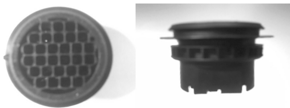
Figura 1. Conector elétrico automotivo na sua vista superior e lateral, injetado com PA 6.6 com 30% CCA.
