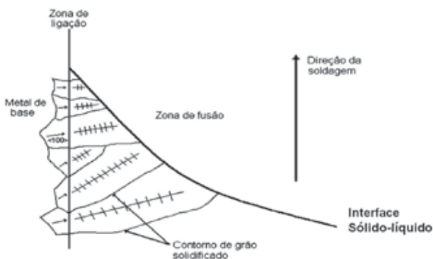
Figura 4. Representação esquemática do crescimento epitaxial e crescimento competitivo dos grãos da ZF [13].
