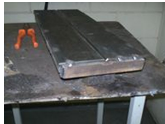
Figura 5 Fixação das chapas no dispositivo.
