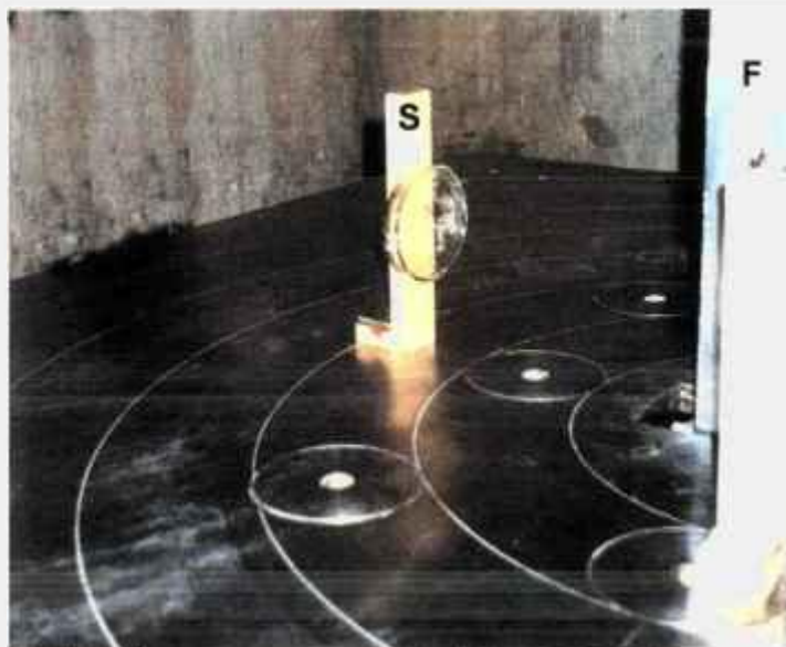
Figura 4 - Larvas de B. glabrata sendo submetidas a irradiação na posição frontal, a 25 cm de distância da fonte ^{60}\text{Co} do tipo panorâmica. F = fonte de ^{60}\text{Co} S= suporte de madeira com placa de Petri contendo desovas de B. glabrata .
