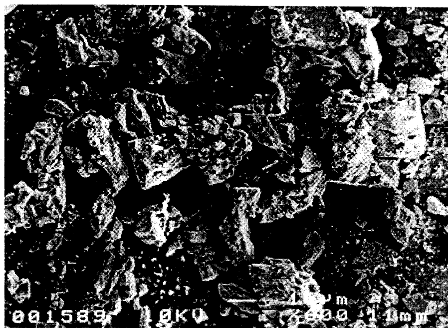
Figura 16 - Micrografia, obtida em microscópio eletrônico de varredura, do pó de ZrO_2 : 7,5 mol% MgO (2,6 % em peso), obtido pela técnica dos citratos.
